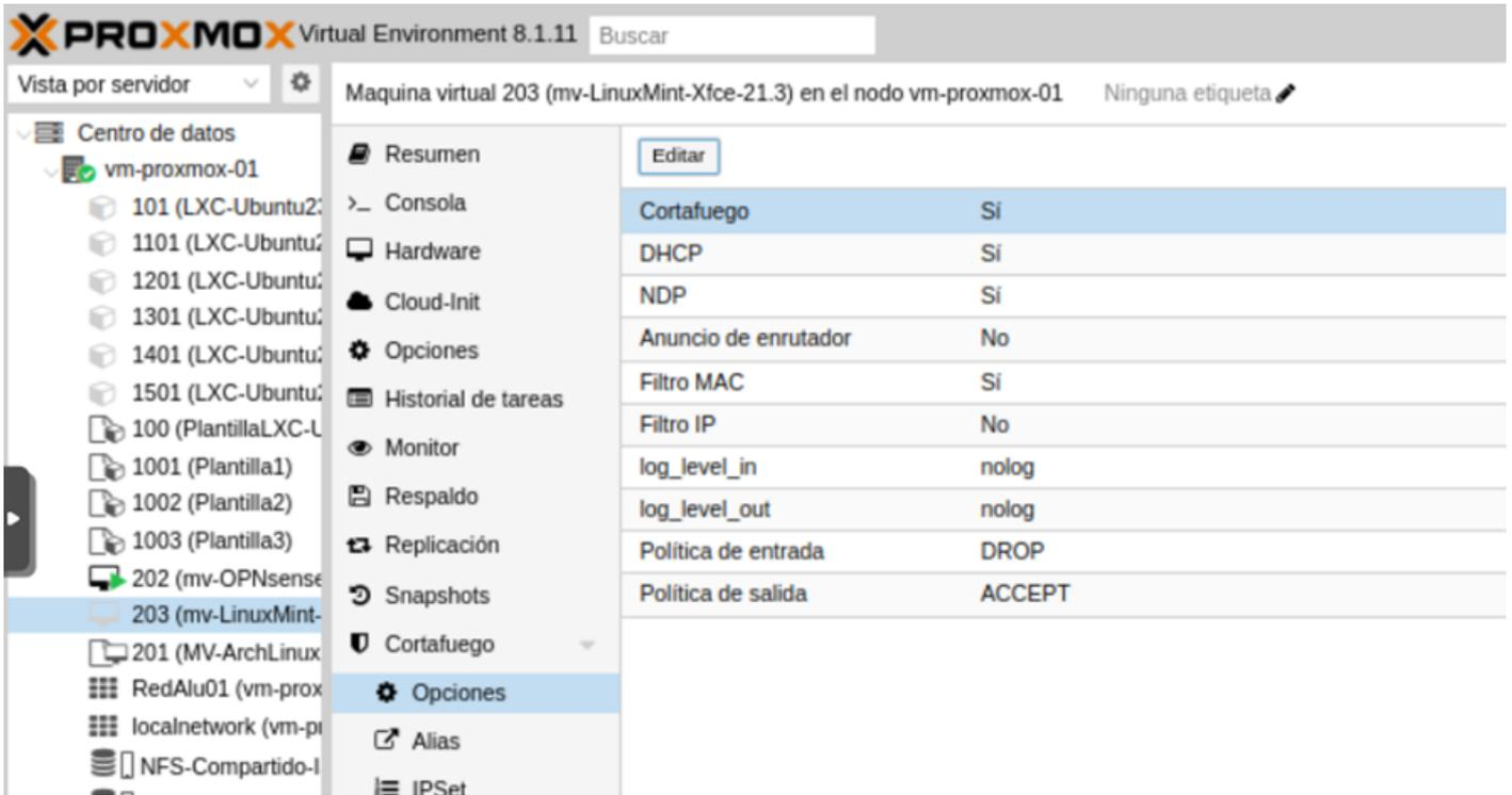
Imagen de elaboración propia: Activar el cortafuego en una MV ( CC BY-NC-SA )
